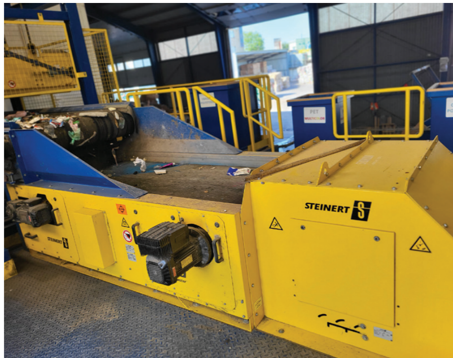
Sestava separátoru železa (vlevo nahoře) a hliníku (v popředí)
