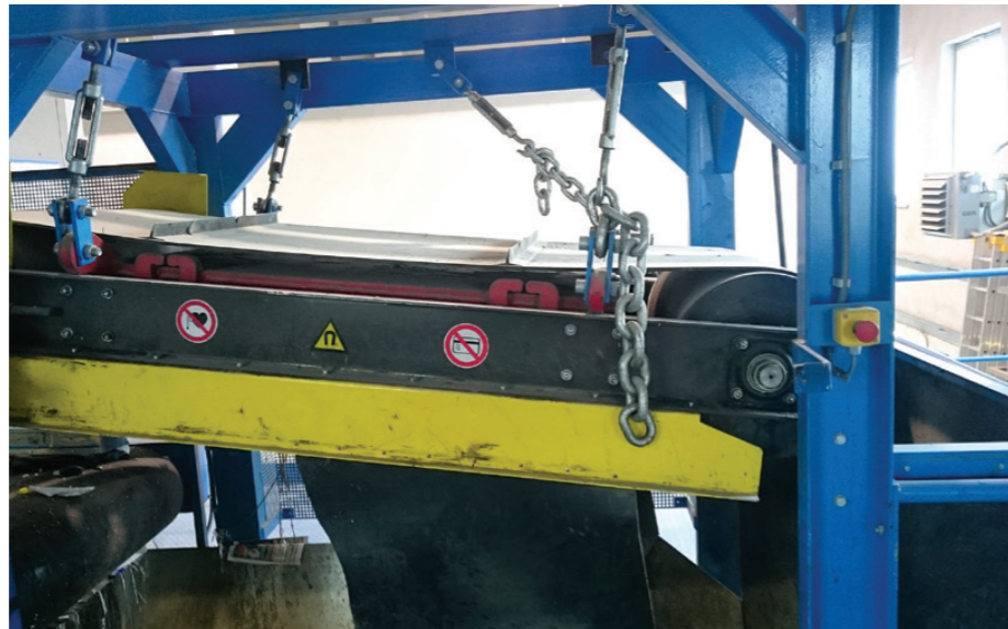
Sestava separátoru železa (vlevo nahoře) a hliníku (v popředí)
