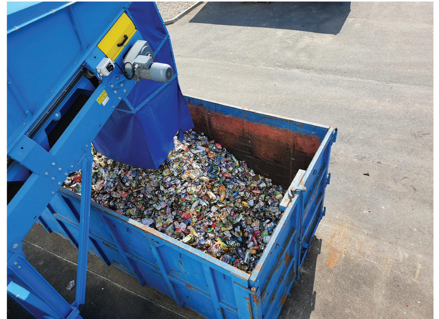
Hliníkové odpady dotříděné z multikomodity pomocí separátoru
